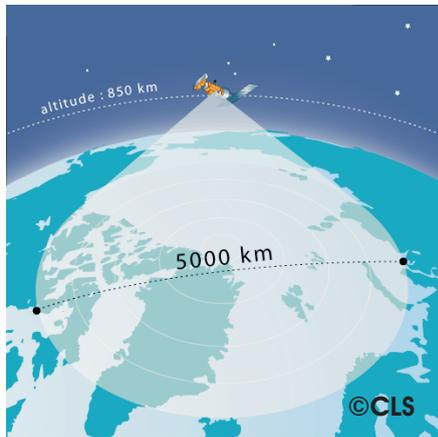
Les satellites de la NOAA sont à orbite *polaire* et *circulaire*. Cela signifie qu'ils sont en mouvement autour de la Terre et passent systématiquement par les deux pôles. Ils se situent à **850km** d'altitude, et mettent environ **100 minutes** pour faire une rotation complète autour de la Terre (ou révolution). On parle de *la période de l'orbite*.
